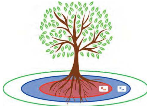
Bild 3: Aufgabenverteilung im Wurzelsystem eines Baums aus mechanischer Sicht. Innerer Bereich: Druckwurzelballen ( R_{DW} = Wurzellerradius aus Windwurfdiagramm). Mittlerer Bereich: mechanisch „aktiver“ Ankerbereich der Zugwurzelplatte ( R_{ZW} ). Außenbereich: Feinwurzeln (physiologisch bedeutsam, weniger mechanisch). (Quelle: Henrik Weiß)
