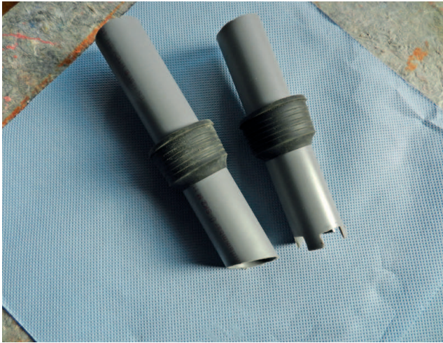
Abb. 5.3: Verschiedene verlängerte Stutzen, die beim Unterdruck- bzw. Saugverfahren zum Einsatz kommen, wenn stehendes Wasser auf der Tragkonstruktion steht.
