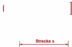
Bild 6.8 Sehfeld des Nivelliers mit Strichkreuz (links), optische Streckenmessung mittels der Distanzstriche (rechts)
