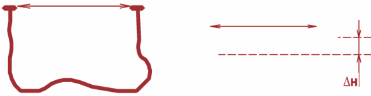
Bild 6.2 Prinzip der kommunizierenden Röhren, Schlauchwaage
