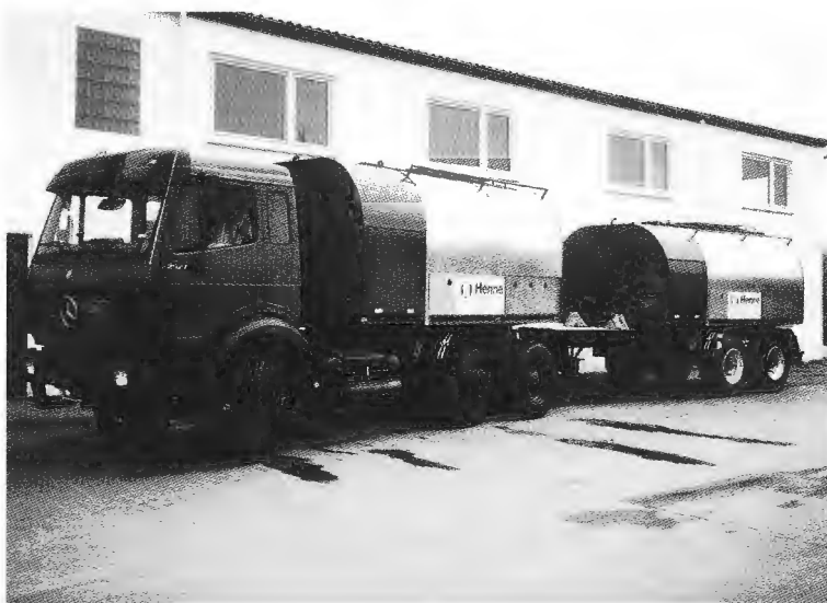
Bild H14 Gussasphalt-Kocher mit liegender Rührwerkswelle
