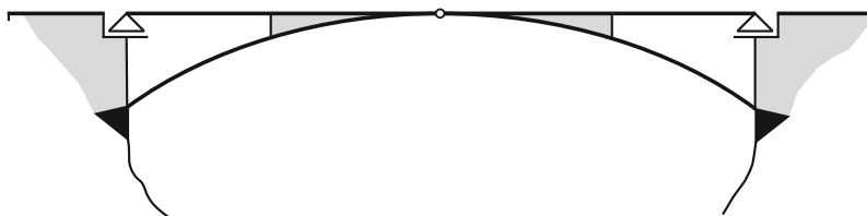
Bild 2-10 Statisches System der Letziwaldbrücke
